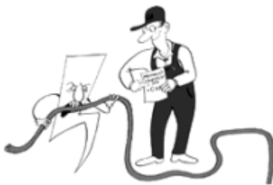
Abb. P10.6: Die Durchgängigkeit bzw. der Widerstand und der Schutzleiter sind zu messen.
