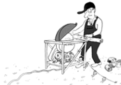
Abb. P10.6: Die Durchgängigkeit bzw. der Widerstand und der Schutzleiter sind zu messen.
