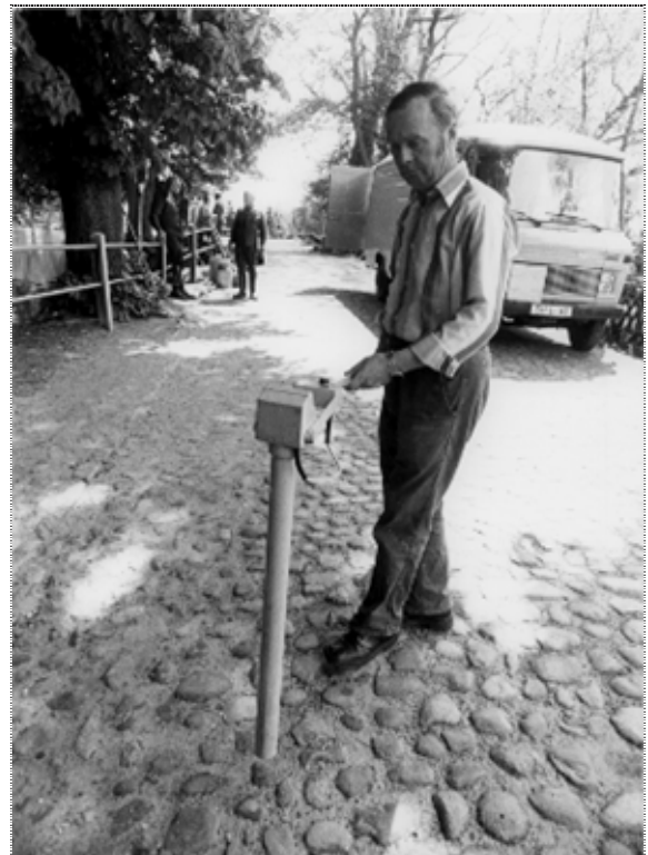
Sucharbeiten auf dem Weg zur Schleusenkuhle. Es wird untersucht, ob eventuell auch unter der Straßenpflasterung Munition verborgen ist - mögliche Verminderung des Weges. (Foto: P. Schiller)
